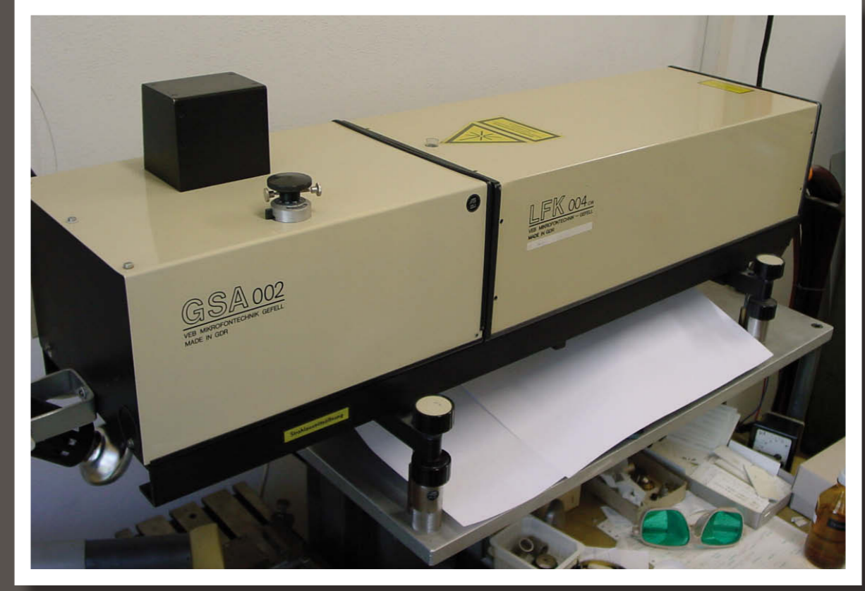
Festkörper-Laser Nd-YAG, Typ LFK 004 / GSA 002 Solid-state laser Nd-YAG, Type LFK 004 / GSA 002
